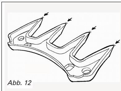
Prüfen Sie, dass Sie einen leichten Schnittgrat auf den vier Messer-Spitzen haben, welche sich bei Berührung nach oben oder unten bewegen lassen (Abb. 12). Prüfen Sie, dass die gesamte Schnittfläche des Messers geschliffen ist und keine stumpfen Flecken vorhanden sind. Wenn Sie nicht sicher sind, schleifen Sie nochmals.
