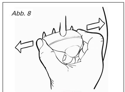
Bewegen Sie das Messer einige Male leicht über die Scheibe mit der Schleifbewegung (Abb. 8). Wenn der Galgen zu weit innen ist, wird das Messer auf der oberen Seite reiben (Abb. 9).
